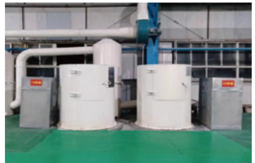
中国矿区钨业选矿二公司通过喷淋装置对配药过程中产生粉尘的回收，职工劳动强度显著降低，粗选药剂制备间整体环境得到显著改善，防止了职业病的发生。
